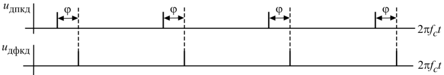
Рис. 2.15. Временные диаграммы напряжений на входах ИФД
